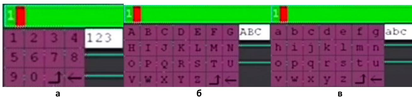
Вид раскладки виртуальной клавиатуры для ввода цифр (а), латинских заглавных букв (б), латинских строчных букв (в)
